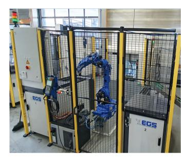
1 Zwei Palettiersysteme vom Typ Sumo Multiplex sorgen für eine Anlagenautonomie von fast zwei Stunden © EGS tischs, dass während der gleichzeitigen Bearbeitung von drei Teilen auf der außen liegenden Tischseite hauptzeitparallel der Teilewechsel erfolgen kann.
