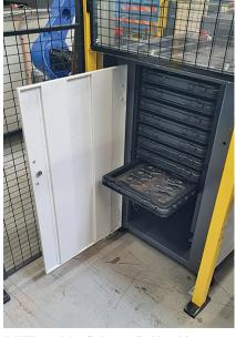
2 Während der Roboter die Maschine beschickt, können jederzeit Paletten eingeschoben und entnommen werden © EGS
